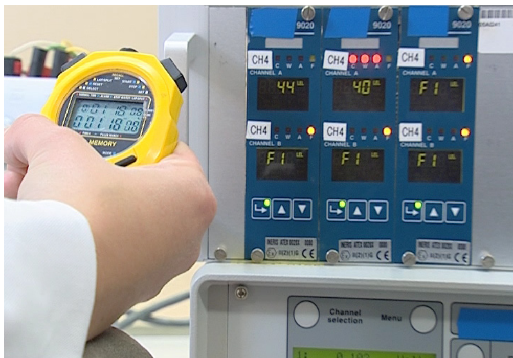
Tests de capteur de CH 4 , photo © INERIS 2008
